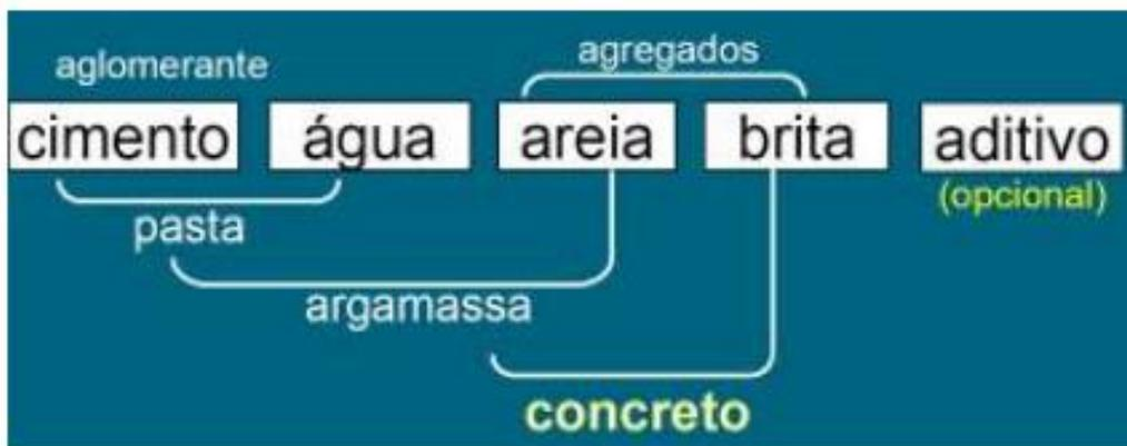
O concreto é um material de construção resultante da mistura, em quantidades racionais, de aglomerante (cimento), agregados (pedra e areia) e água. Logo após a mistura o concreto deve possuir plasticidade suficiente para as operações de manuseio, transporte e lançamento em formas, adquirindo coesão e resistência com o passar do tempo, devido às reações que se processam entre aglomerante e água. Em alguns casos são adicionados aditivos que modificam suas características físicas e químicas.
